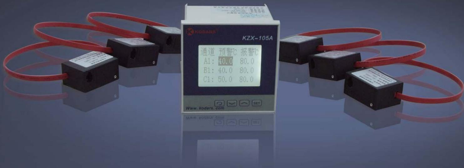
**EM系列开关柜无线温度监测预警系统**是利用无线温度传感器与高压带电体等电位测量温度数据，采用前沿的ZigBee组网技术，实现了高压带电体温度的远距离遥测；系统具有低功耗、数据无线传输、精度高、响应速度快、操作灵活、组网方便等特点。
